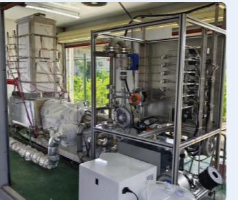
10kW级SOFC电堆模组控制平台
