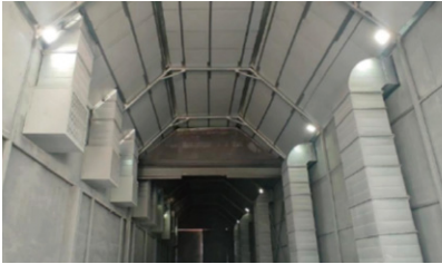
风机塔筒制造车间漆雾净化设备
