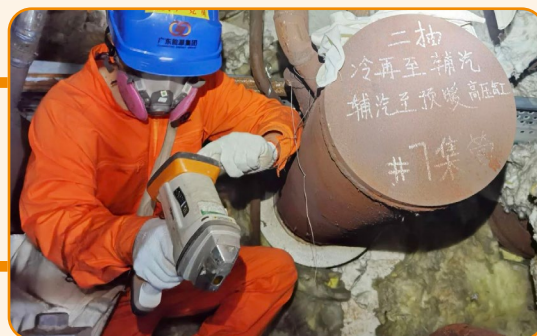
检修人员进行疏水管弯头金相检测
