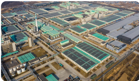
康辉新材料厂房屋顶建设太阳能光伏发电
