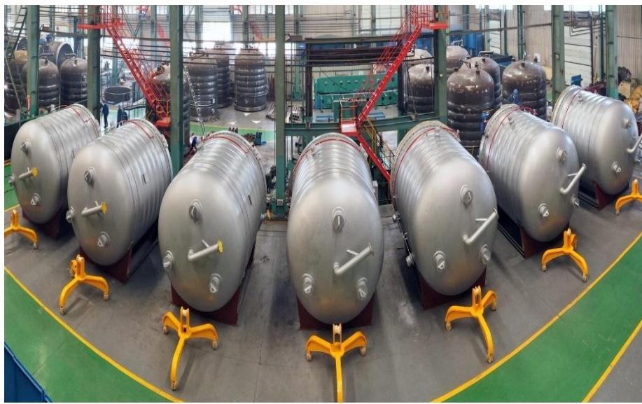
图 4. 多晶硅还原炉
