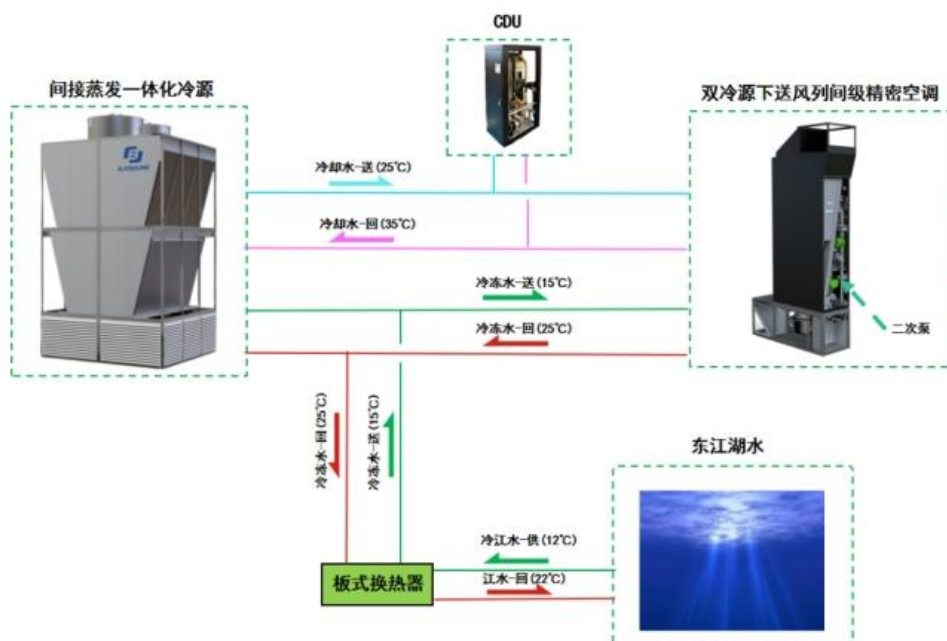
资兴智算中心制冷系统结构图
