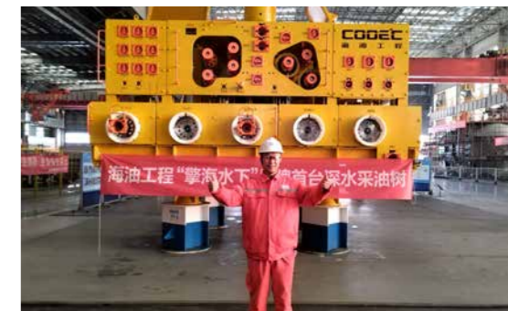
中国首套 2000 米级深水采油树安装完成
