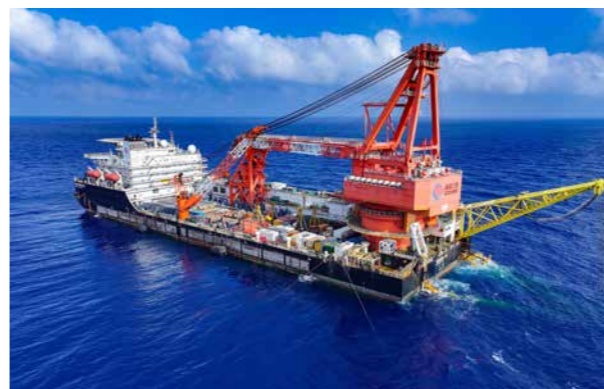
“海洋石油 202” 船海管铺设现场
