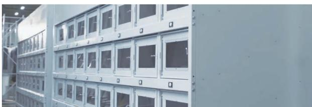
作为立体化智能播种分拣设备，它通过自动扫码与调度接驳实现多订单的极速精准分拣。支持8大出入库场景的灵活配置，能贴合一线多样化作业需求，相比纯人工播种，效率提升50%-300%。
