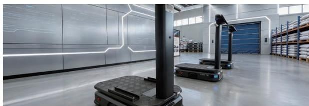
公司在多库区拣选场景投运AMR机器人，其具备路径规划能力，能在动态复杂环境中实现货物的柔性搬运与智能流转。通过智能任务拆分与组合，优化机器人移动路径，避免拣货点位拥堵，相比人工拣货，设备拣货效率提升30%。
