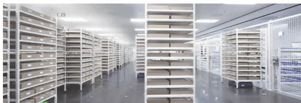
由超高密度货架与潜伏式AGV组成，空间利用率极高，适用于小体积物品存储。公司与某国际知名光学眼镜龙头企业共建的战略合作示范基地，通过构建多层次精细化库存管理与容器追踪体系，以及全链路追溯能力，实现库存实时可视与精细化管理，可完成镜片等超小件的自动化拆零拣选，精准加工与装配，助力客户日均出库数万片，准确率超99%。
