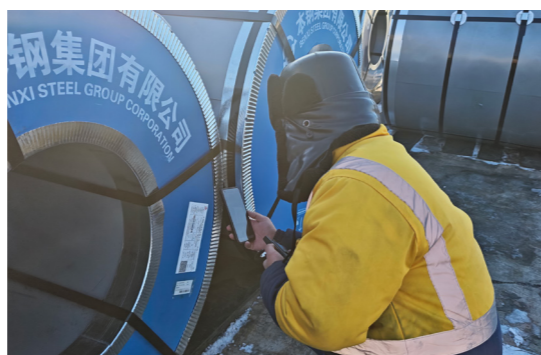
现场理货员通过终端设备扫码录入货件归垛作业，并记录场区地理位置及归垛工组
