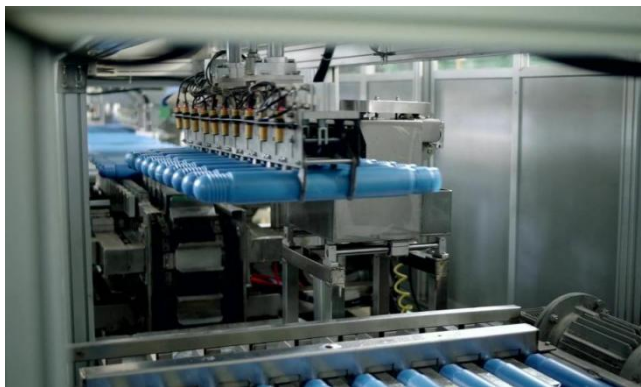
震源药柱生产线
