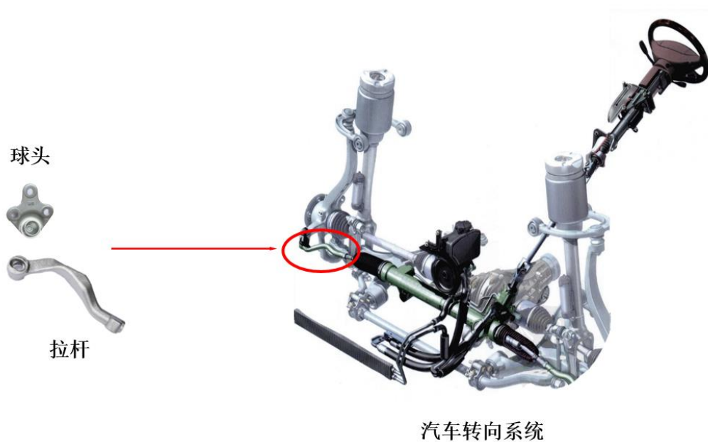
图：球头拉杆在汽车转向系统中的位置示意图
