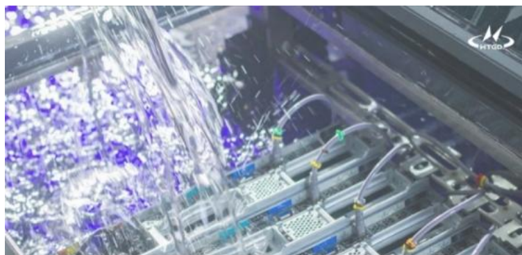
亨通浸没式液冷系统
