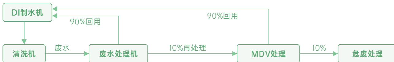
废水处理回用，实现生产废水零外排
