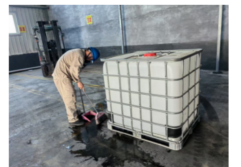
冲洗地面，收集废水
