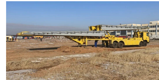
2025年12月，中船应急携100米硬质机动路面与26米应急机械化桥参演，重点参与了“断路”场景下快速搭建陆上救援通道环节
