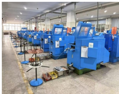
采用新式双金属复合触头冷压焊机
