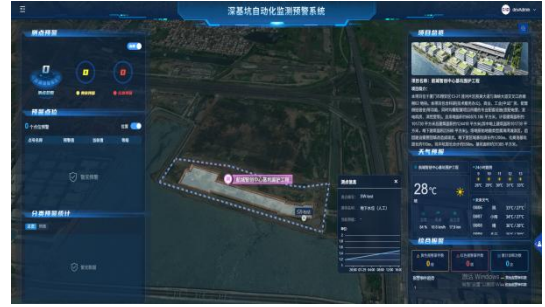
图示：深基坑自动化监测预警系统
