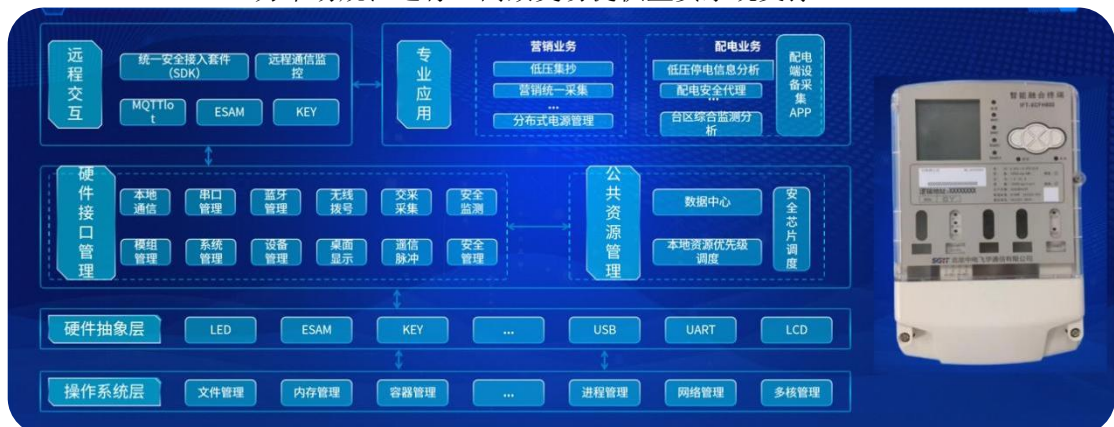
图 11 智能融合终端产品示意图（注：为本板块代表产品，作为电网数字化“末梢神经中枢”，实现台区智慧自治，为低压电网高质量发展提供重要支撑。）
