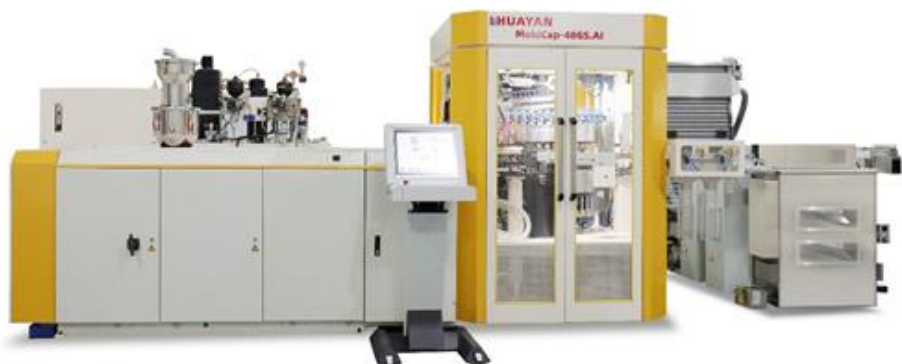
图 2 瓶盖压塑成型系统
