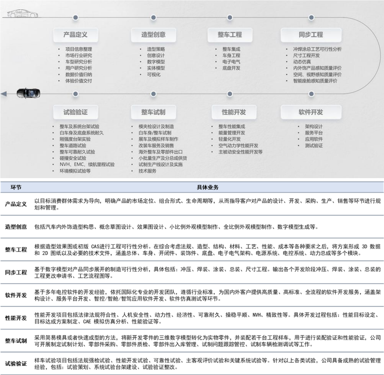
图 2：整车研发业务流程及环节定义
