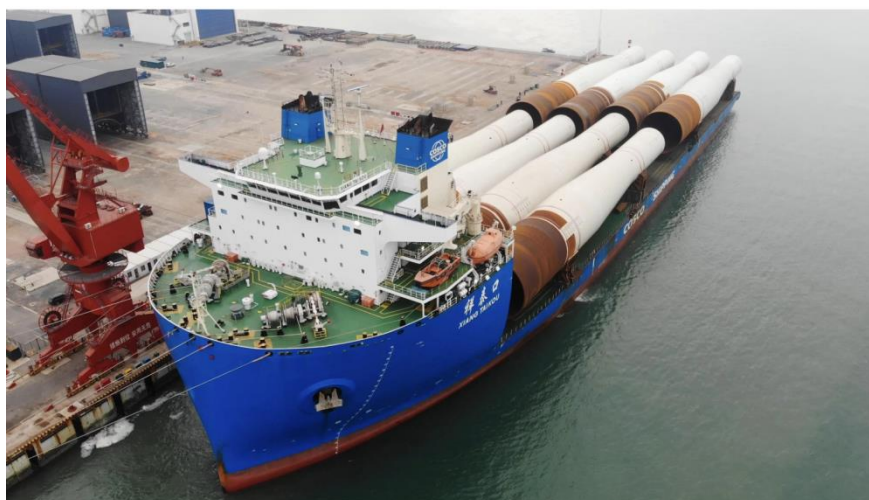
图：单桩运输船舶需侧向泊靠码头、从而方便单桩侧滚装船
