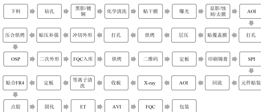
图：FPC 组件工艺流程图
