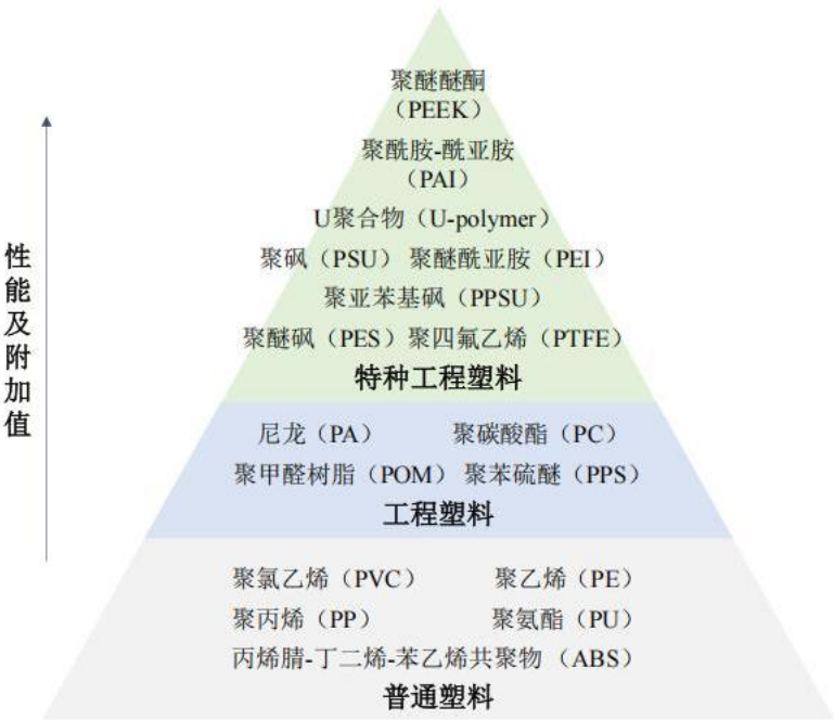
图：常用普通塑料、工程塑料及特种工程塑料示意图
