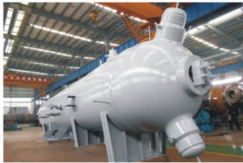
350MW高压加热器
