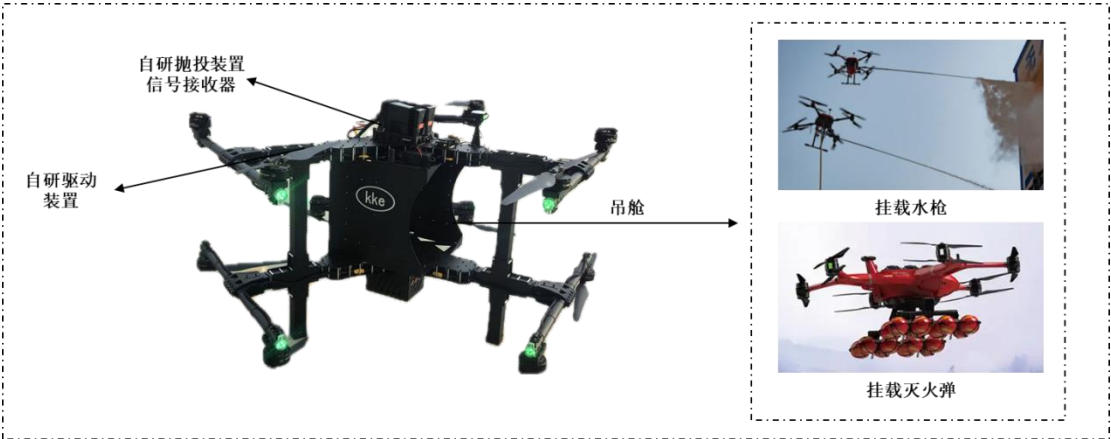
标的公司自研双层十二翼面民用灭火无人机
