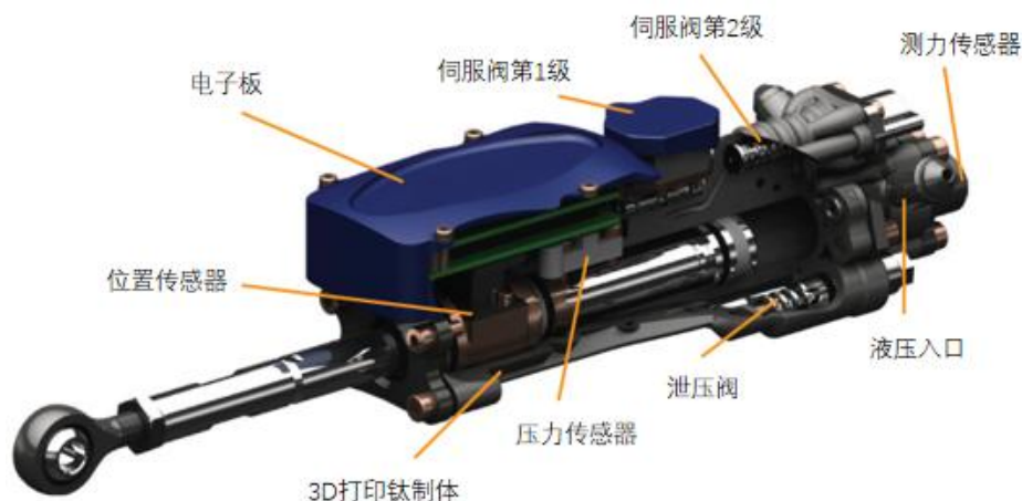
电液驱动关节结构示意图
