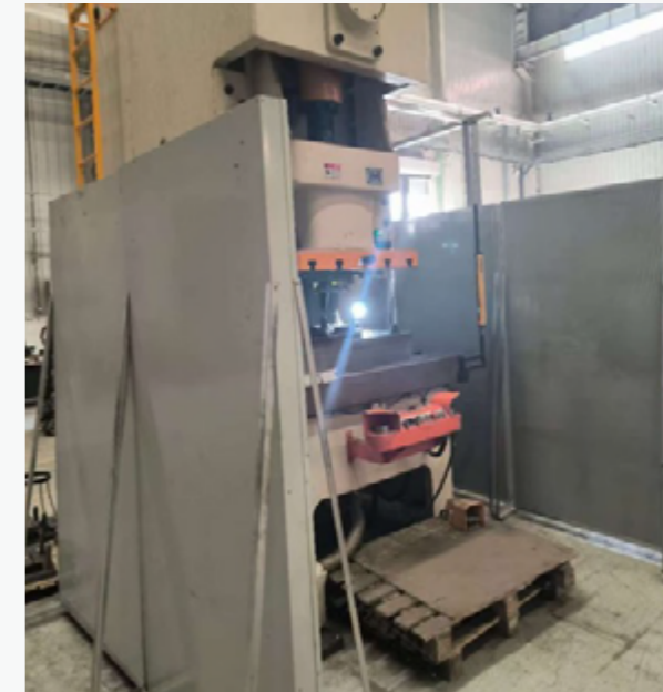
为生产线冲床加装“降噪声屏障”以减少噪声污染
